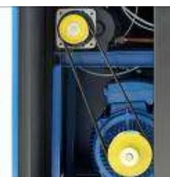
**Винтовой блок ЕВОЗ-НК** производится фабрикой Rotorcomp (Германия) и является основой винтового компрессора. Визуально он представляет собой чугунный корпус, внутри которого на подшипниках размещены два ротора, сжимающие воздух.
