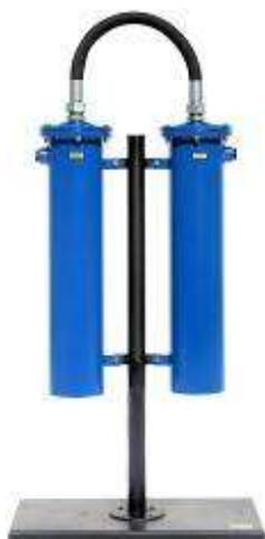
Фильтрационный модуль предназначен для тонкой очистки сжатого воздуха и различных газов от аэрозолей масла и влаги, а также от твердых частиц размером более 3 мкм. Обеспечиваемое остаточное содержание аэрозоля масла - менее 5 мг/м<sup>3</sup>. Используется в системах пневмоуправления и автоматики, пневмоприводе устройств и инструмента для окраски поверхностей распылением.
