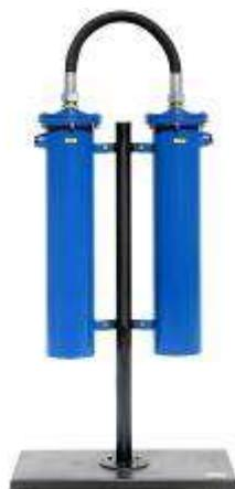
Фильтрационный модуль предназначен для тонкой очистки сжатого воздуха и различных газов от аэрозолей масла и влаги, а также от твердых частиц размером более 3 мкм. Обеспечиваемое остаточное содержание аэрозоля масла - менее 4 мг/м<sup>3</sup>. Используется в системах пневмоуправления и автоматики, пневмоприводе устройств и инструмента для окраски поверхностей распылением.
