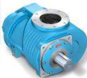
**Винтовой блок EVO42** производится фабрикой Rotorcomp (Германия) и является основой винтового компрессора. Визуально он представляет собой чугунный корпус, внутри которого на подшипниках размещены два ротора, сжимающие воздух.
