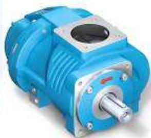
**Винтовой блок EVO6** производится фабрикой Rotorcomp (Германия) и является основой винтового компрессора. Визуально он представляет собой чугунный корпус, внутри которого на подшипниках размещены два ротора, сжимающие воздух.
