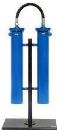
Фильтрационный модуль предназначен для тонкой очистки сжатого воздуха и различных газов от аэрозолей масла и влаги, а также от твердых частиц размером более 3 мкм. Обеспечиваемое остаточное содержание аэрозоля масла - менее 5 мг/м<sup>3</sup>. Используется в системах пневмоуправления и автоматики, пневмоприводе устройств и инструмента для окраски поверхностей распылением.
