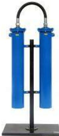
Фильтрационный модуль предназначен для тонкой очистки сжатого воздуха и различных газов от аэрозолей масла и влаги, а также от твердых частиц размером более 3 мкм. Обеспечиваемое остаточное содержание аэрозоля масла - менее 4 мг/м<sup>3</sup>. Используется в системах пневмоуправления и автоматики, пневмоприводе устройств и инструмента для окраски поверхностей распылением.
