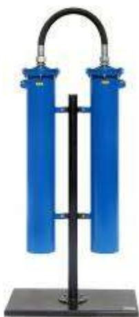
Фильтрационный модуль предназначен для тонкой очистки сжатого воздуха и различных газов от аэрозолей масла и влаги, а также от твердых частиц размером более 3 мкм. Обеспечиваемое остаточное содержание аэрозоля масла - менее 4 мг/м<sup>3</sup>. Используется в системах пневмоуправления и автоматики, пневмоприводе устройств и инструмента для окраски поверхностей распылением.
