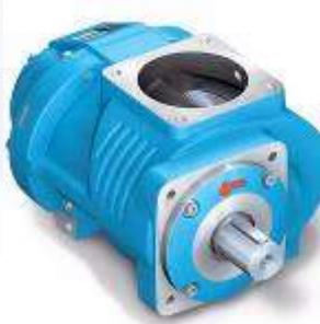
**Винтовой блок EVO9** производится фабрикой Rotorcomp (Германия) и является основой винтового компрессора. Визуально он представляет собой чугунный корпус, внутри которого на подшипниках размещены два ротора, сжимающие воздух.
