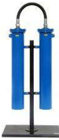
Фильтрационный модуль предназначен для тонкой очистки сжатого воздуха и различных газов, от аэрозолей масла и влаги, а также от твердых частиц размером менее 3 мкм. Обеспечиваемое остаточное содержание аэрозоля масла - менее 4 мг/м<sup>3</sup>. Используется в системах пневмоуправления и автоматики, пневмоприводе устройств и инструмента для окраски поверхностей распылением.
