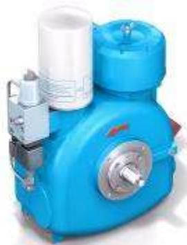
**Винтовой блок NK-31** производится фабрикой Rotorcomp (Германия) и является основой винтового компрессора. Визуально он представляет собой чугунный корпус, внутри которого на подшипниках размещены два ротора, сжимающие воздух.
