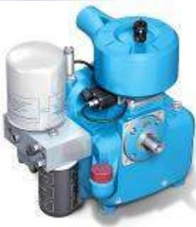
**Винтовой блок ЕВОЗ-НК** производится фабрикой Rotorcomp (Германия) и является основой винтового компрессора. Визуально он представляет собой чугунный корпус, внутри которого на подшипниках размещены два ротора, сжимающие воздух.
