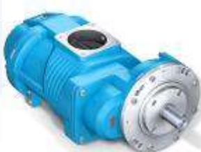
**Винтовой блок EVO15G** производится фабрикой Rotorcomp (Германия) и является основой винтового компрессора. Визуально он представляет собой чугунный корпус, внутри которого на подшипниках размещены два ротора, сжимающие воздух.
