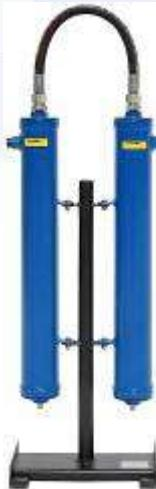
Фильтрационный модуль предназначен для тонкой очистки сжатого воздуха и различных газов от аэрозолей масла и влаги, а также от твердых частиц размером более 3 мкм. Обеспечиваемое остаточное содержание аэрозоля масла - менее 5 мг/м<sup>3</sup>. Используется в системах пневмоуправления и автоматики, пневмоприводе устройств и инструмента для окраски поверхностей распылением.
